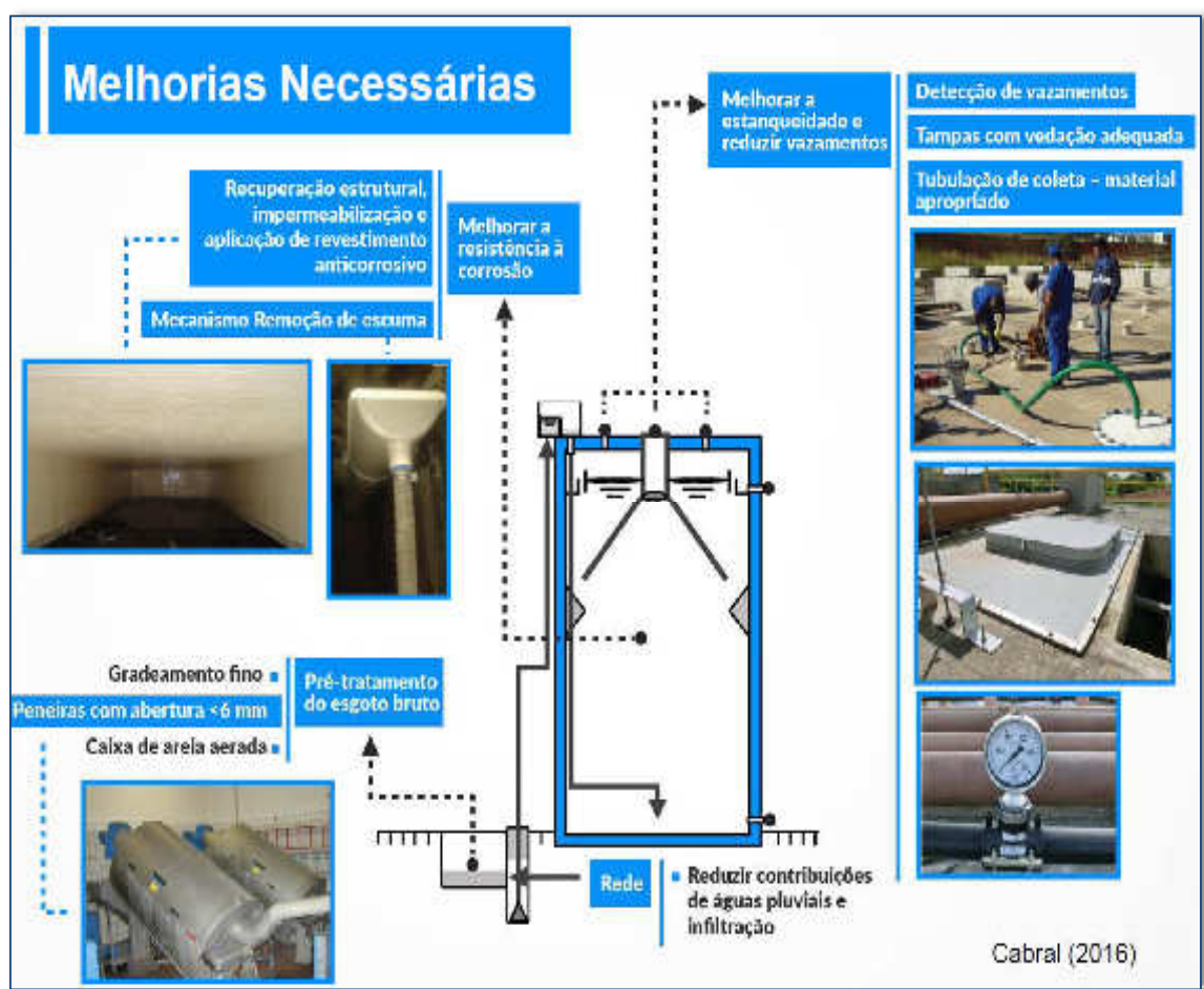
Figura 4.4 – Melhorias recomendadas para reatores UASB. Cabral (2016) Fonte: Cabral (2016)
